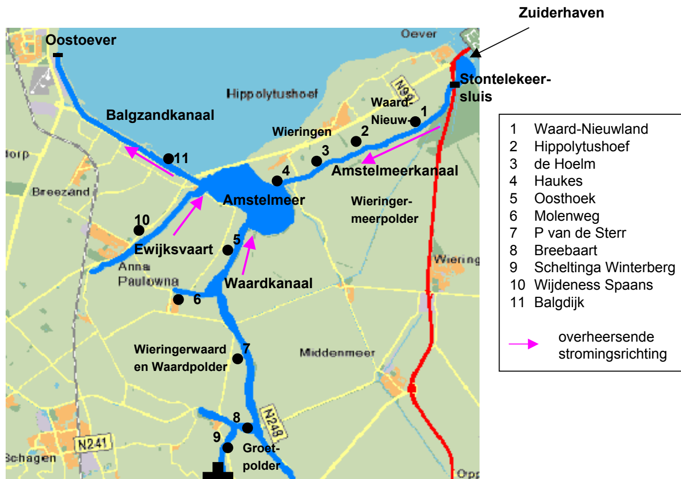
Afbeelding 1.1. Wateraan- en afvoersysteem van de Amstelmeerboezem
