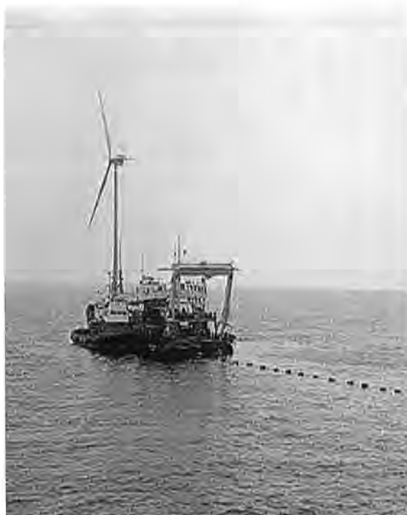
Figuur 3.7: Kabellegschip (Bron: Hornsrev)
