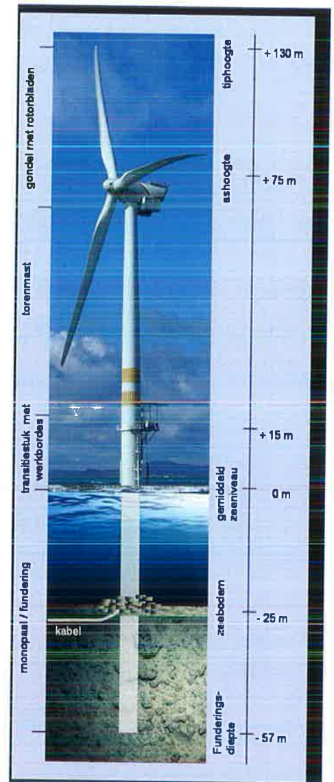
Figuur 3: opbouw van de windturbine (3.6 MW)
