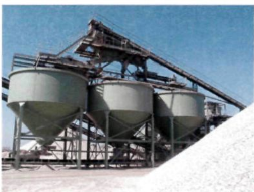
8. Geklassificeerde fractie worden separaat opgeslagen in fractiesilo's
