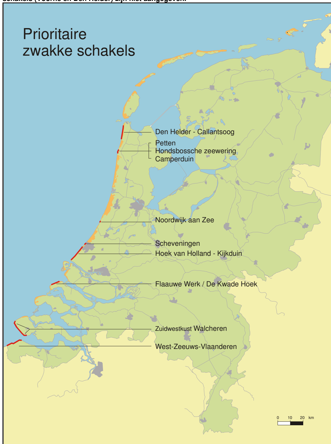
Figuur 7.1: Prioritaire zwakke Schakels langs de Nederlandse kust. De niet prioritaire zwakke schakels (Voorne en Den Helder) zijn niet aangegeven.
