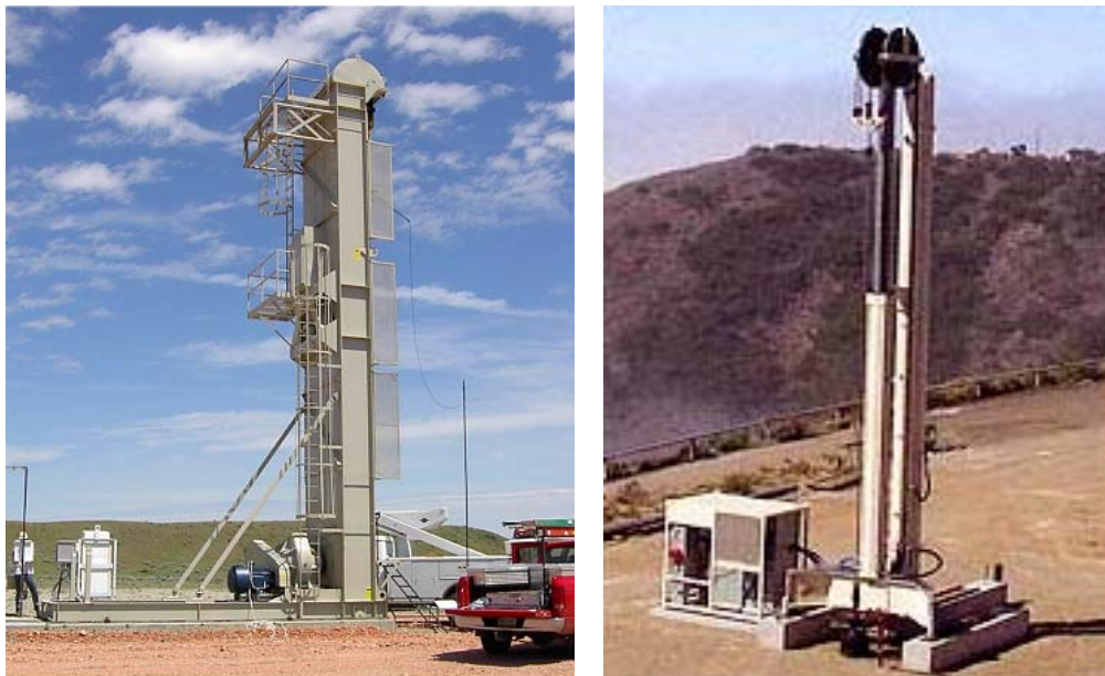
Figuur 4.4 Twee voorbeelden van een verticale hefinrichting
