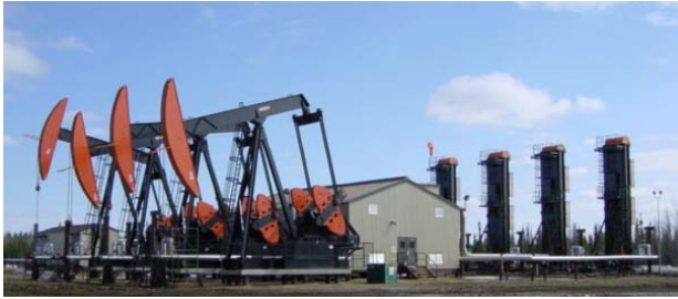
Figuur 10: Conventionele jaknikkers (links) naast een zgn. Rotaflex (rechts), Project Peace River Canada.
