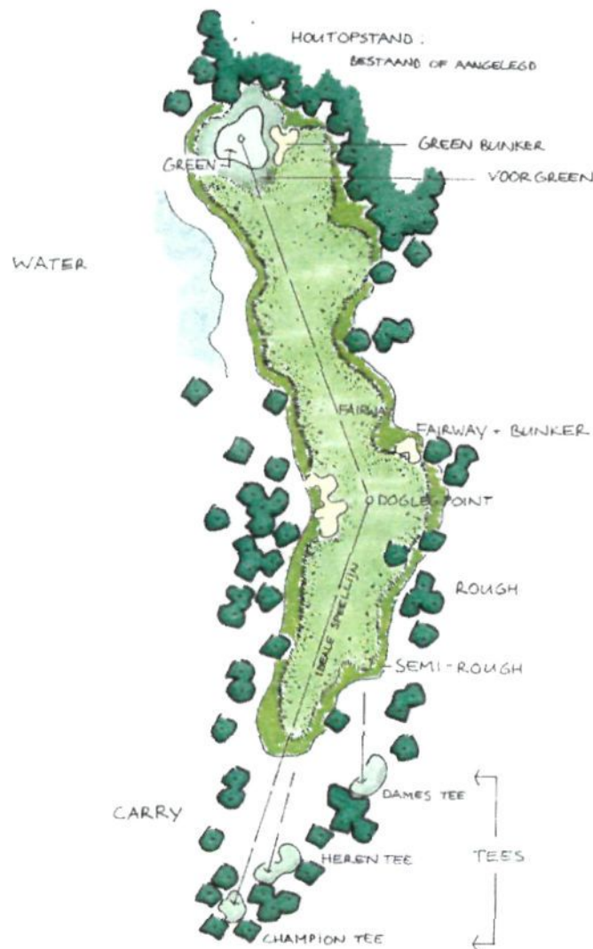
Figuur 5.1 Schematisch overzicht van een hole
