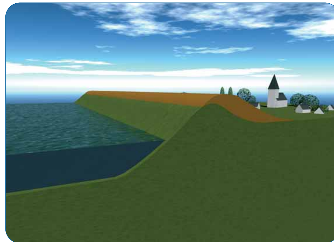
> Figuur 11: Dijkverhoging door vergroting van het dijklichaam
