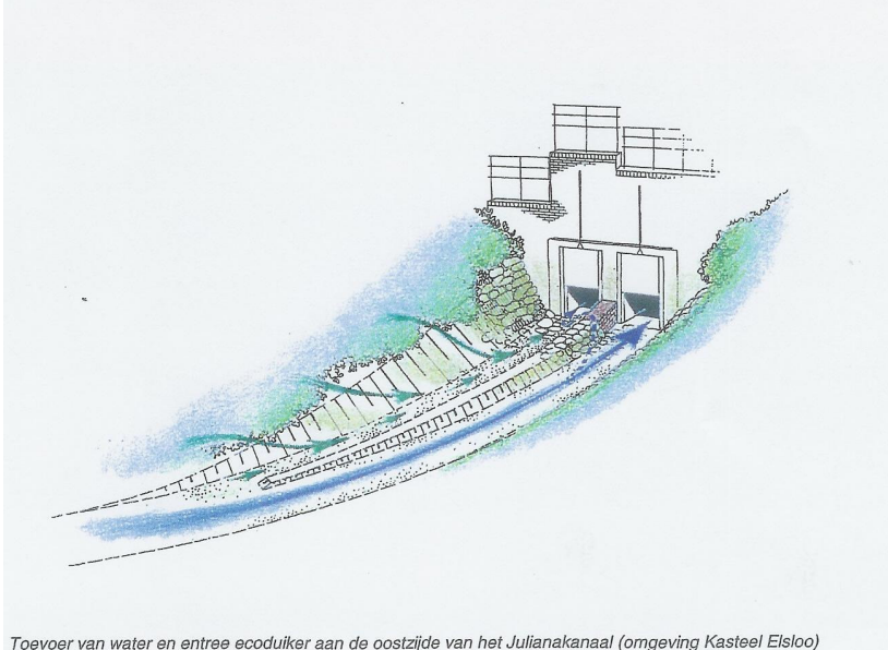
Toevoer van water en entree eco-duiker aan de oostzijde van het Julianakanaal (omgeving Kasteel Elsloo)
