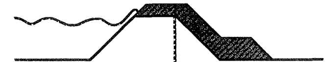
oplossing: constructiefscherm i.c.m. kruinverhoging (V+VI)
