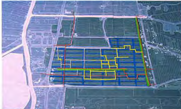
fase 1: Graven van de weteringen in het zuidelijk deel. Aanleg van de kades en infrastructuur vindt gelijktijdig plaats zodat het gebied direct toegankelijk wordt.
