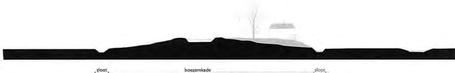
Doorsnede boezemkade huidige situatie
