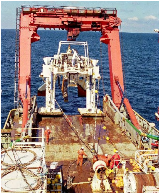
figuur3.6 Een ploeg wordt te water gelaten vanaf het begeleidende schip (bron: Metoc)
