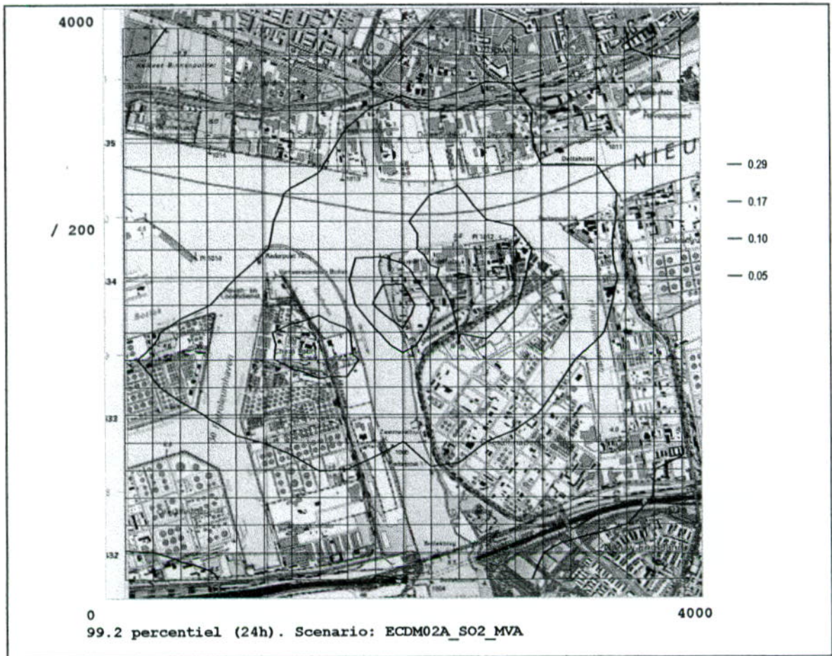
Figuur k: Isoconcentratielijnen voor \text{SO}_2 in \mu\text{g}/\text{m}^3 als 99,2 percentielwaarde van 24h gemiddelden (MMA).
