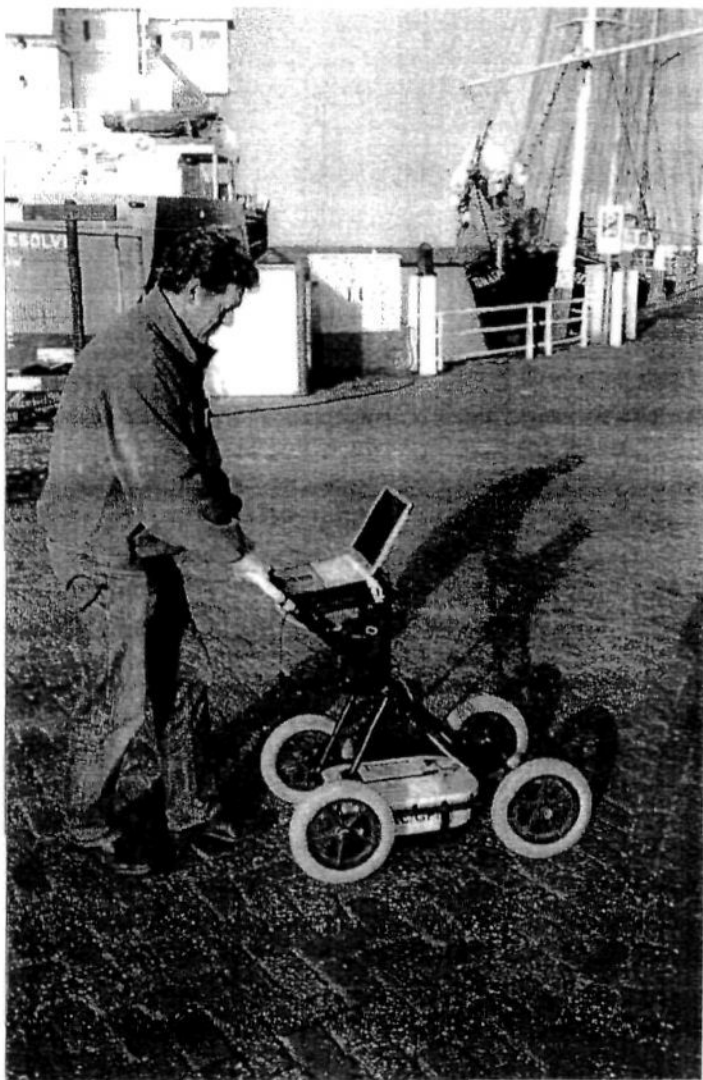
Figuur 3 RAMAC X3M radar systeem (500MHz) van Malå Geoscience met GPS registratie.
