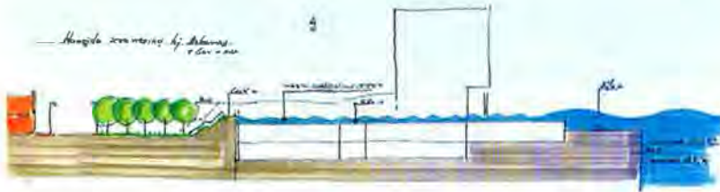
De zeewering wordt een geïntegreerd onderdeel van het bouwplan waardoor de zeewering minder hoog hoeft te worden.
