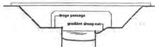
Passage onder brug
