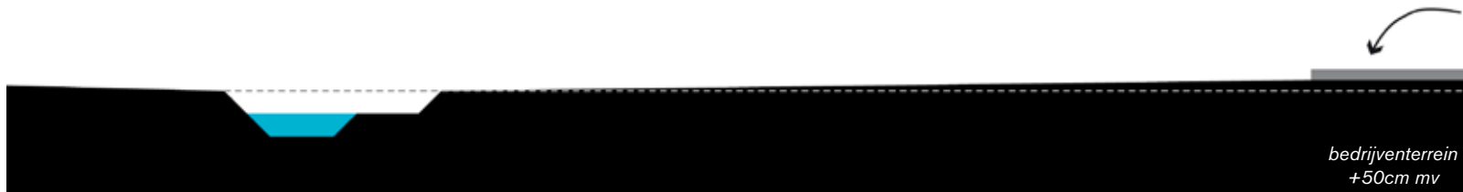
realisatie bedrijventerrein +50cm maaiveld
