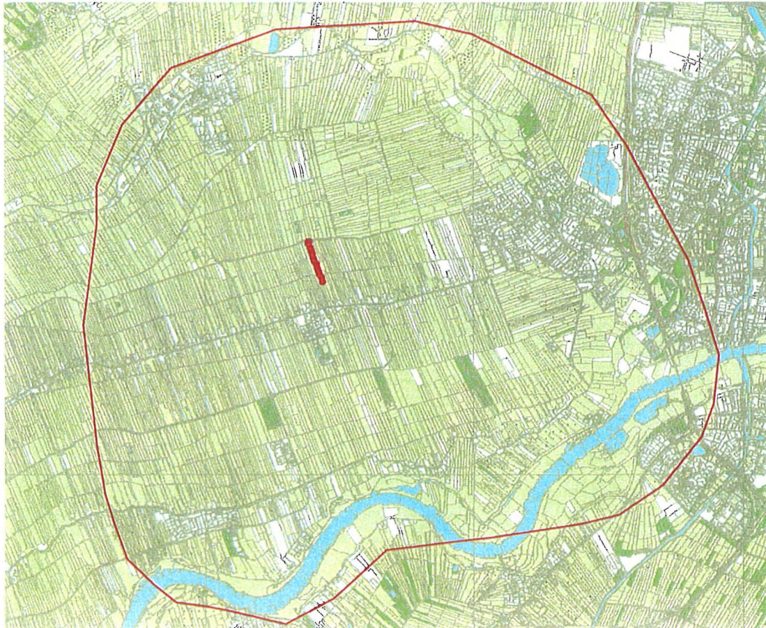
Figuur 3b: maximale beïnvloedingsgebied kwel- en infiltratieflux
