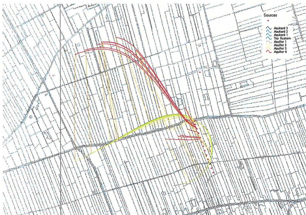
Figuur 5: stroombaanberekeningen infiltraat
