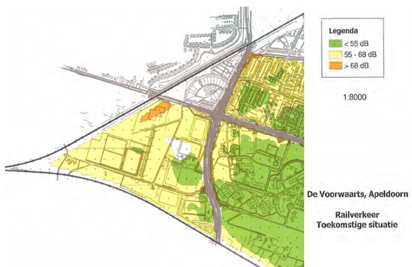
Figuur 5.7. Geluidbelasting railverkeer (situatie 2020)
