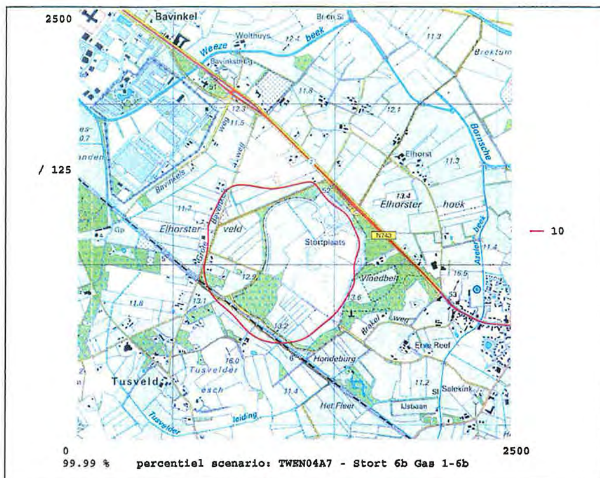
Figuur w Geurcontour van 10 ge/m 3 als 99,99-percentielwaarde als gevolg van Elhorst-Vloedbelt in de aangevraagde situatie bij storten in compartiment 6b (het rekengebied is 2.500 x 2.500 m, het geïmprementeerde gebied is 7% groter dan het rekengebied)
