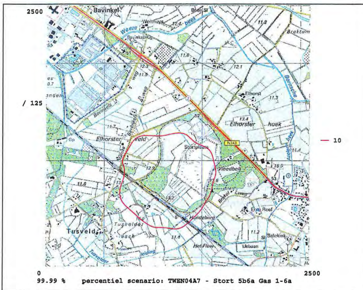
Figuur v Geurcontour van 10 ge/m 3 als 99,99-percentielwaarde als gevolg van Elhorst-Vloedbelt in de aangevraagde situatie bij storten in compartiment 5b+6a (het rekengebied is 2.500 x 2.500 m, het geïllustreerde gebied is 7% groter dan het rekengebied)
