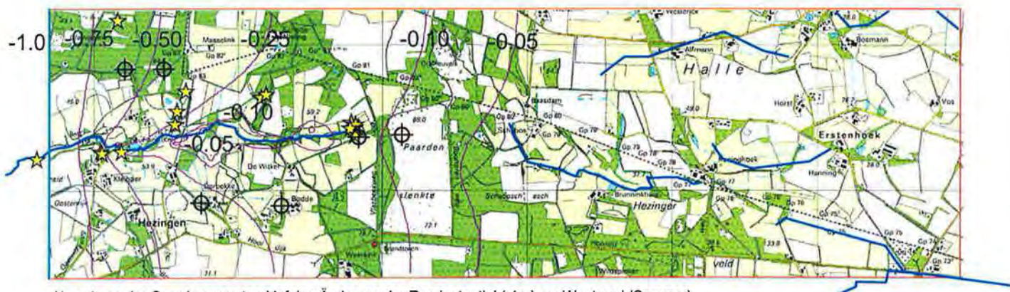
Absenkung der Grundwasserstand infolge Änderung der Randpotential (-1m) am Westrand (Sommer) Grondwaterstandverlaging als gevolg van een verlaging van de randpotentiaal (-1m) op de westelijke rand van de stuwwal (zomer)
