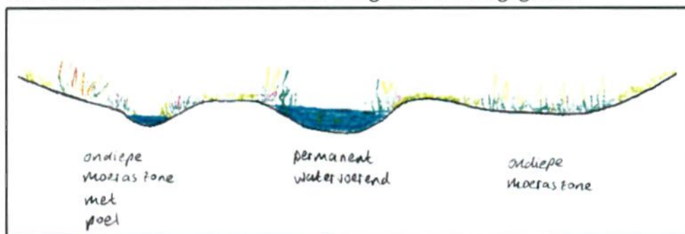
figuur 7-6: Principeschets Horstmoeras [50]
