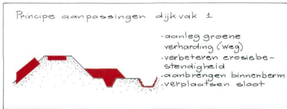
Figuur 11: dwarsdoorsnede aanpassingen dijkvak 1
