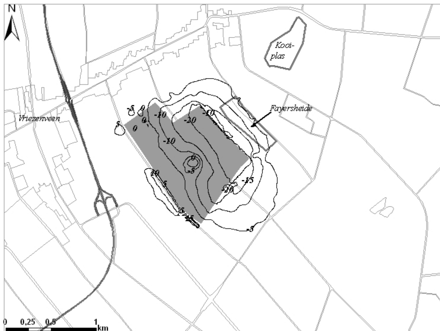
figuur 5.7 Natuur- en Recreatiealternatief (zandwinning beëindigd): Wijziging stijghoogte watervoerend pakket 1 (interval 0,05 m). De plas is met een grijze kleur aangegeven
