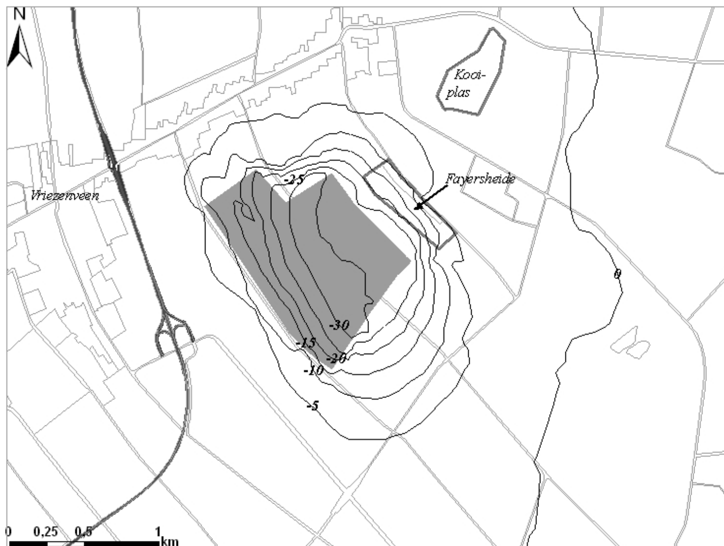
figuur 5.8 Natuur- en Recreatiealternatief (eindfase zandwinning): Wijziging stijghoogte watervoerend pakket 1 (interval 0,05 m). De plas is met een grijze kleur aangegeven
