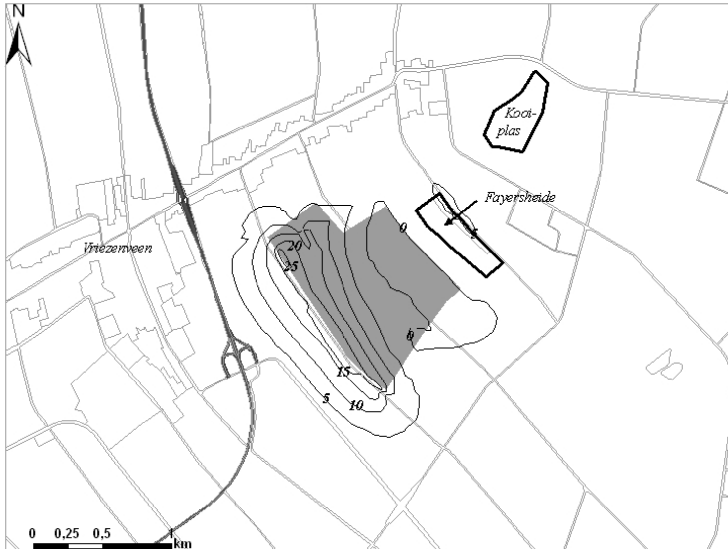
figuur 7.1 MMA (zandwinning beëindigd):: Wijziging stijghoogte watervoerend pakket 1 (interval 0,05 m). De plas is met een grijze kleur aangegeven
