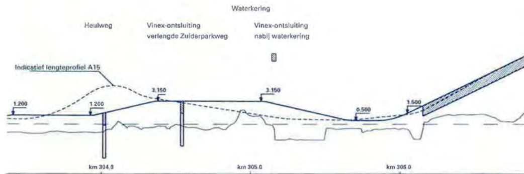
Variant A, Kortsluitroute over de waterkering
