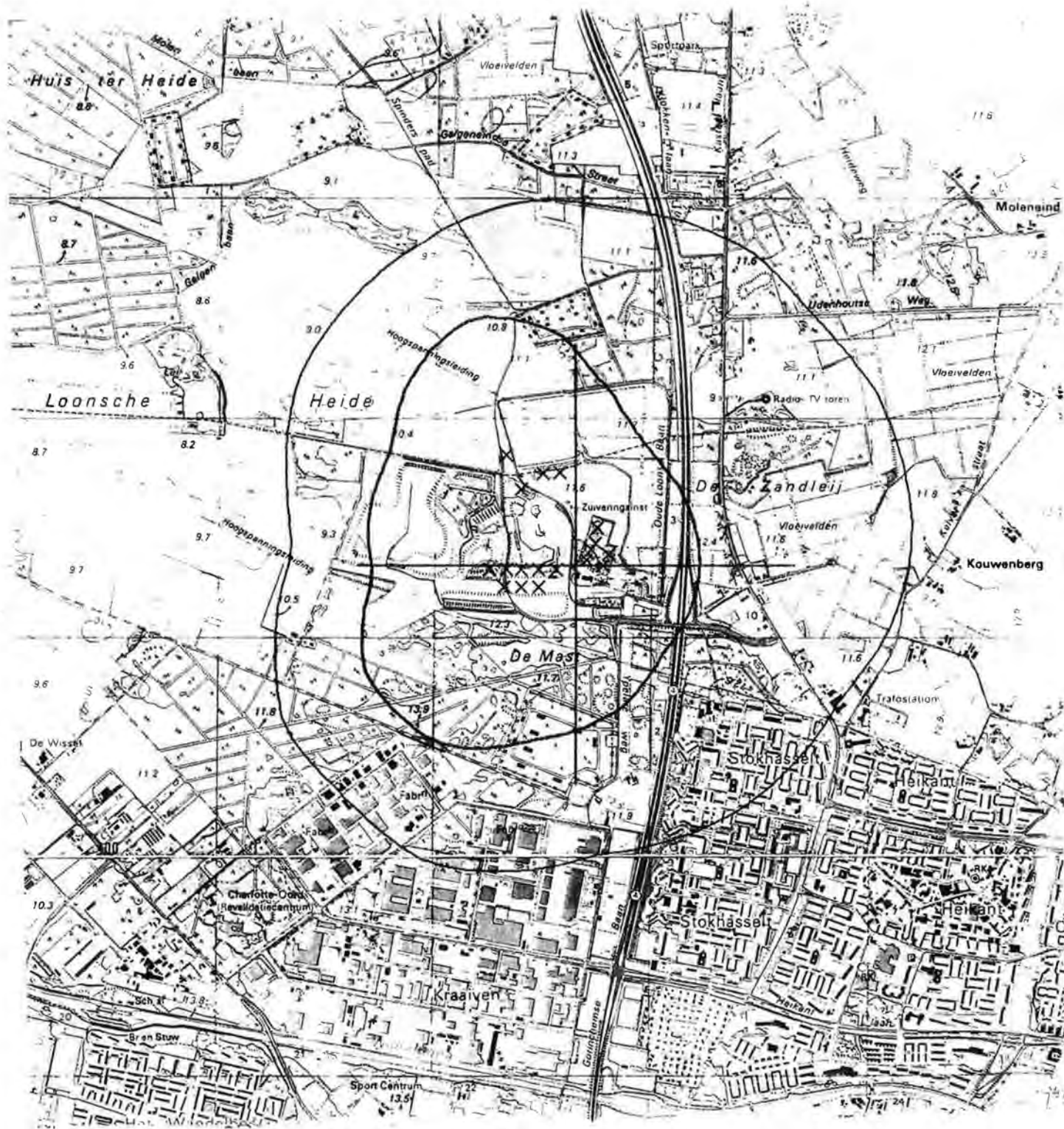
Figuur 6: De 98-percentielcontourlijnen van 1 \text{ Ge} \cdot \text{m}^{-3} in de gebruiksfase na 2008 ten gevolge van de geuremissies van vuilstortplaats De Spinder (binnenste dikkere lijn) en ten gevolge van de GFT-vergistingsinstallatie en de AWRI-Noord samen (buitenste dunne lijn). (Schaal: 1:25.000)
