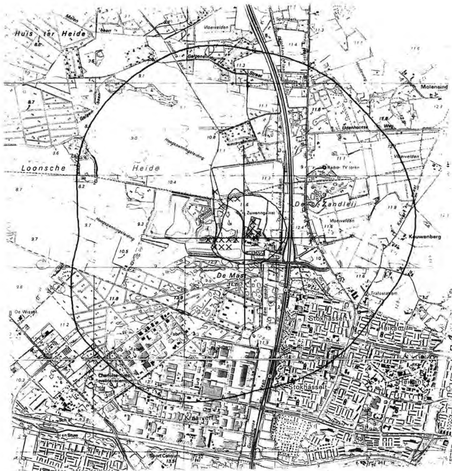
Figuur 4: De 98-percentielcontourlijnen van 1 \text{ Ge} \cdot \text{m}^{-3} en 10 \text{ Ge} \cdot \text{m}^{-3} in de gebruiksfase na 2008 cumulatief ten gevolge van geuremissies van vuilstortplaats De Spinder, de GFT-vergistingsinstallatie en de AWRI-Noord. (Schaal: 1:25.000)
