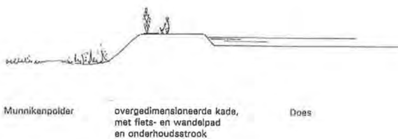
figuur 13: Doorsnedes inrichting kades
