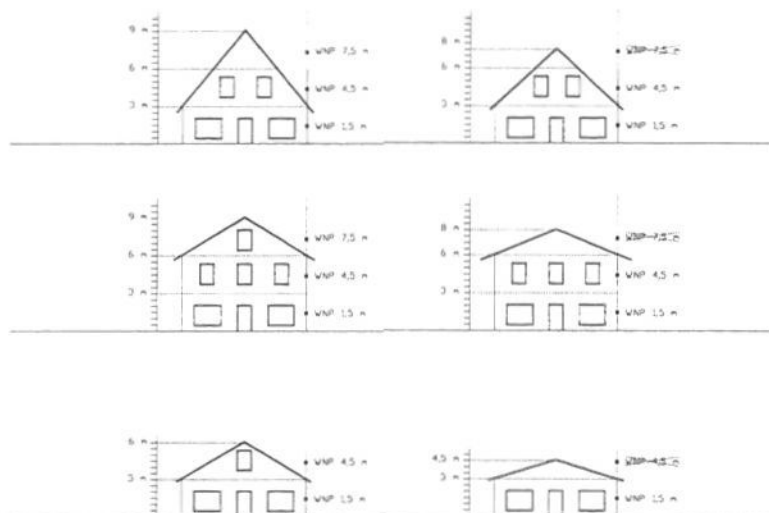
Figuur 5-2 Schematische weergave keuze waarneemhoogten
