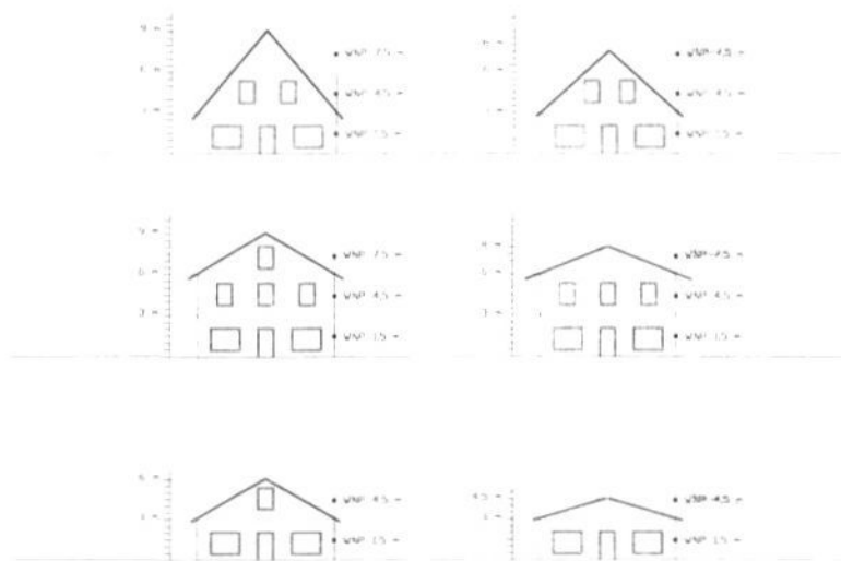
Figuur 5-3 Schematische weergave keuze waarneemhoogten
