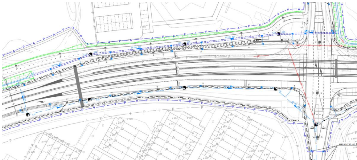
Afbeelding 3.23 Nieuwe duikerverbinding tussen de noordzijde Nijenoord Allee met de duikers aan de zuidzijde Nijenoord Allee - Churchillweg
