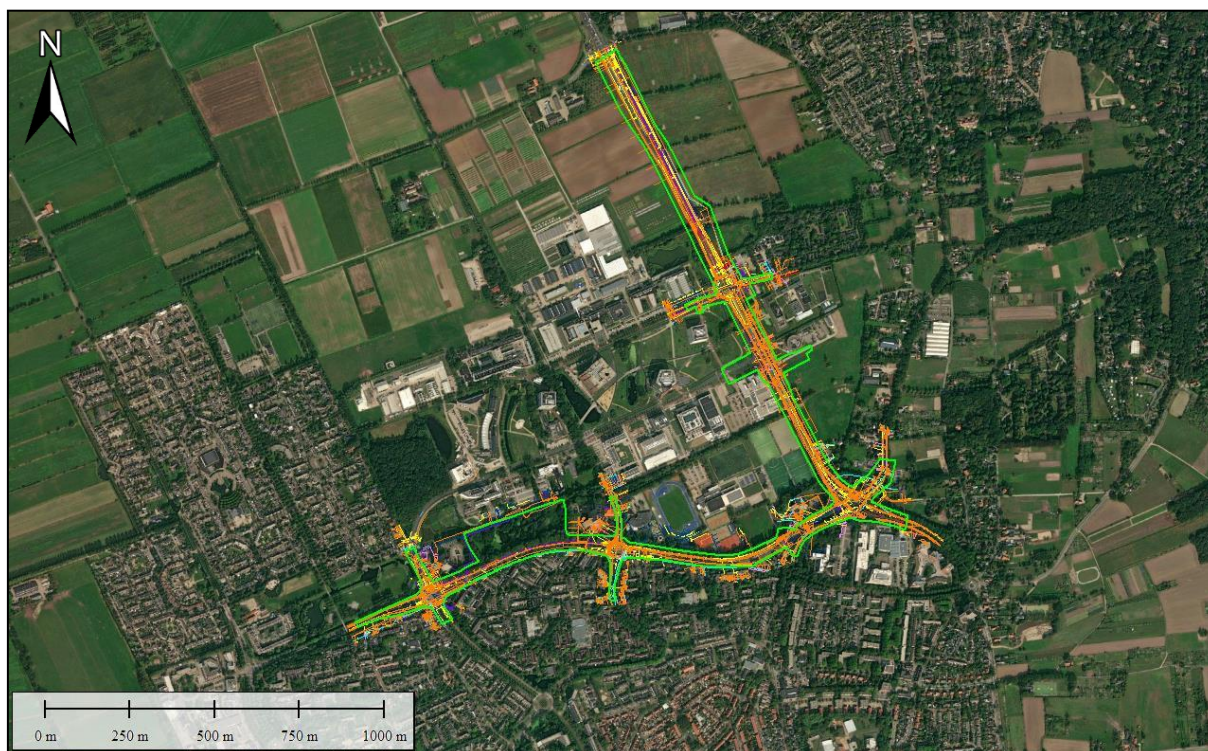
Figuur 27. Het geheel aan kabel- en leidingentracés binnen het projectgebied, waaronder waterleiding, riolering, datatransport, midden- en laagspanning, etc. Bron satellietbeeld: World Imagery.
