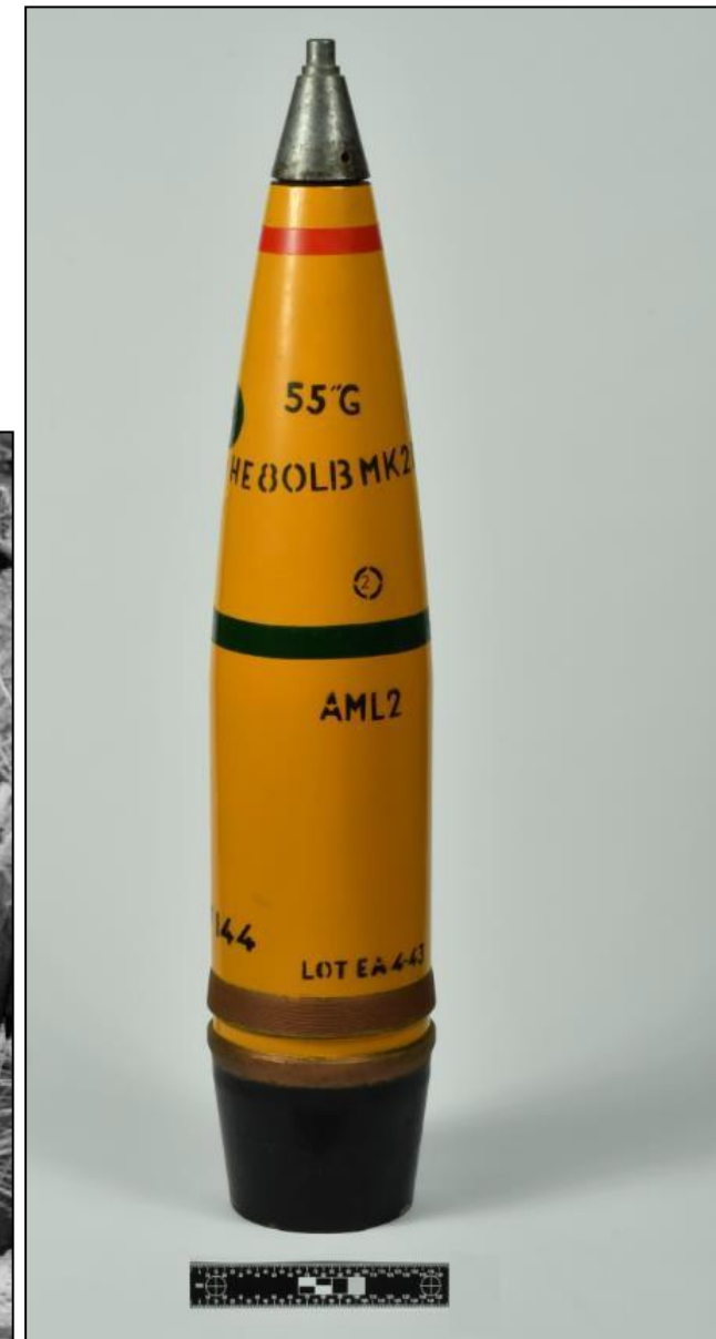
Figuur 32-34. Links: diverse schematische weergaven van de No 119 ontsteker. Links-onder: de bemanning van een stuk 5,5 inch in actie. Rechts: een brisantgranaat 5,5 inch (80 lb Mk I) nieuwstaat. Bron: collectie BeoBOM.
