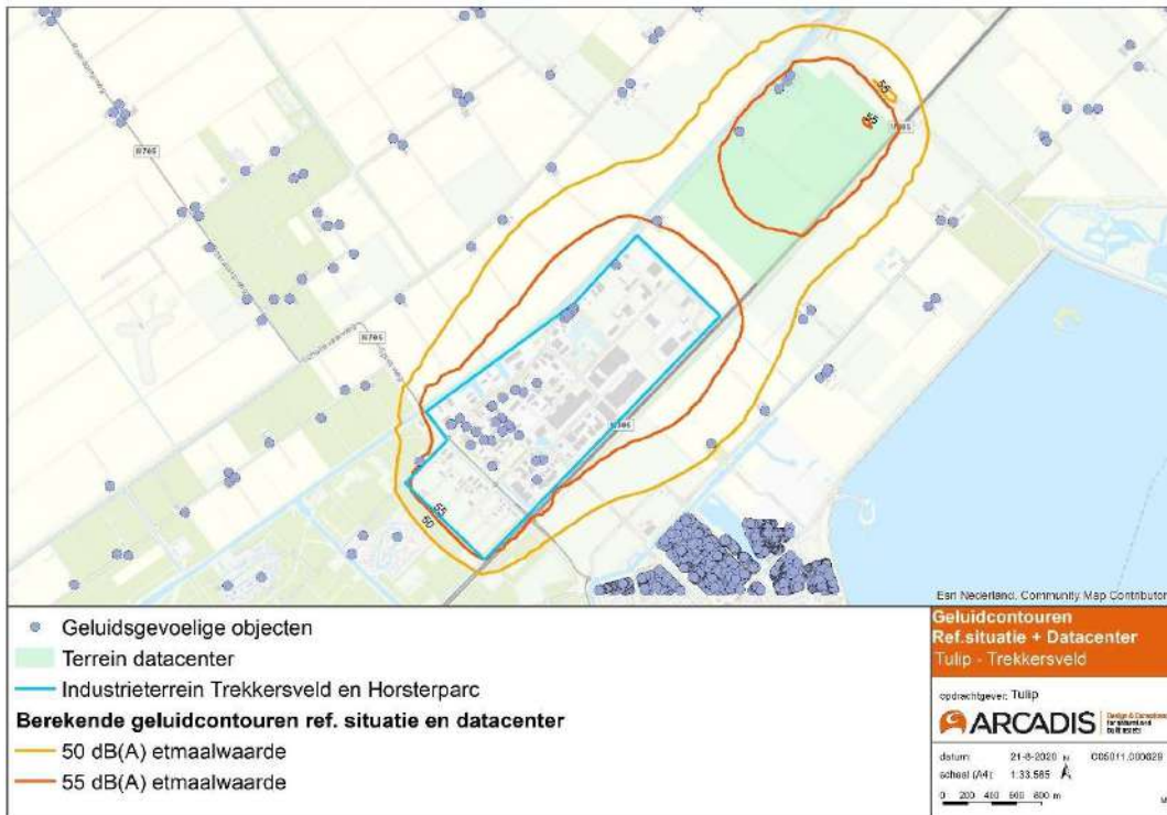
Figuur 16-17: Geluidcontouren bedrijventerrein Trekkersveld na uitbreiding met campus met datacenter, transformatorstation en schakelstation
