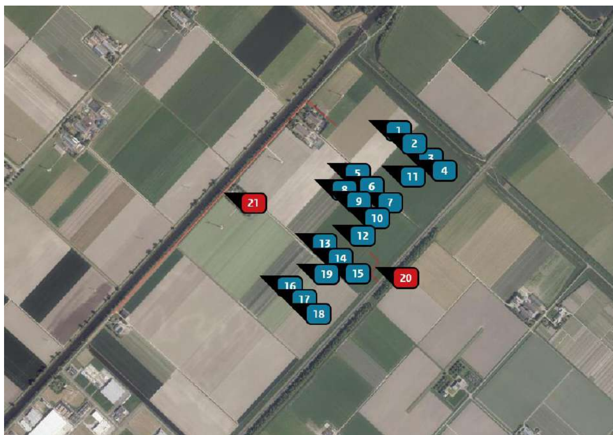
Afbeelding 3: Ligging van de generatoren (bron 1 t/m 19) en de ontsluitingswegen in de gebruiksfase van het datacenter (bron 20 en 21)
