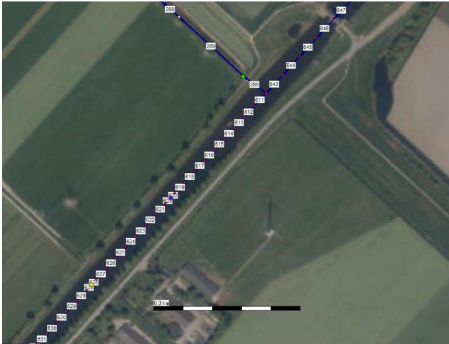
Figuur A.2. Schematisatie van het model in reken-segmenten (aangegeven met nummers) in de Hoge Vaart in de buurt van inlaat- en uitlaatpunt. Paarse ruit: uitlaatpunt (segment 620). Gele ruit: inlaatpunt (segment 628, op 200 m ten zuidwesten van het uitlaatpunt). Segment 643 ligt 250 m van het uitlaatpunt naar het noordoosten.
