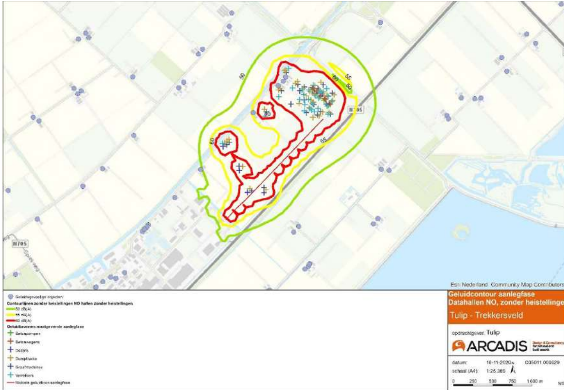
Figuur 16-12: Dagwaarde geluidcontour 50, 55 en 60 dB(A) maatgevende aanlegfase met grondwerkzaamheden, bouw datahallen 1 en 2, substation en andere gebouwen exclusief heiwerkzaamheden (rood=60 dB(A), geel= 55 dB(A), groen= 50 dB(A) – contour).
