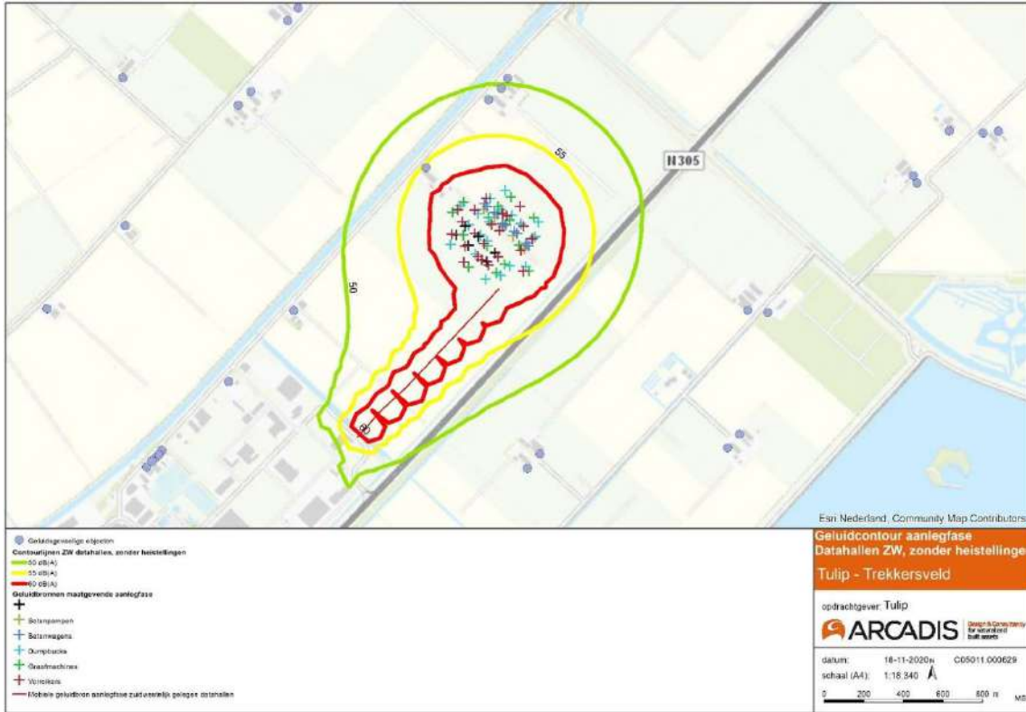
Figuur 16-14: Dagwaarde geluidcontour 50, 55 en 60 dB(A) aanlegfase meest zuidwestelijk gelegen datahallen, exclusief heiwerkzaamheden (rood=60 dB(A), geel= 55 dB(A), groen= 50 dB(A) – contour).
