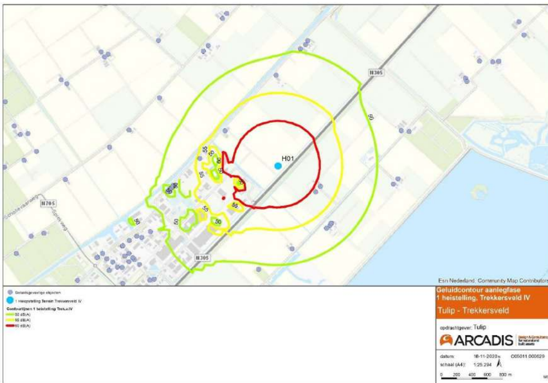
Figuur 16-15: Dagwaarde geluidcontour 50, 55 en 60 dB(A) bouwfase met één heiofstelling op 35 ha bedrijventerrein Trekkersveld IV (rood=60 dB(A), geel= 55 dB(A), groen= 50 dB(A) – contour.)
