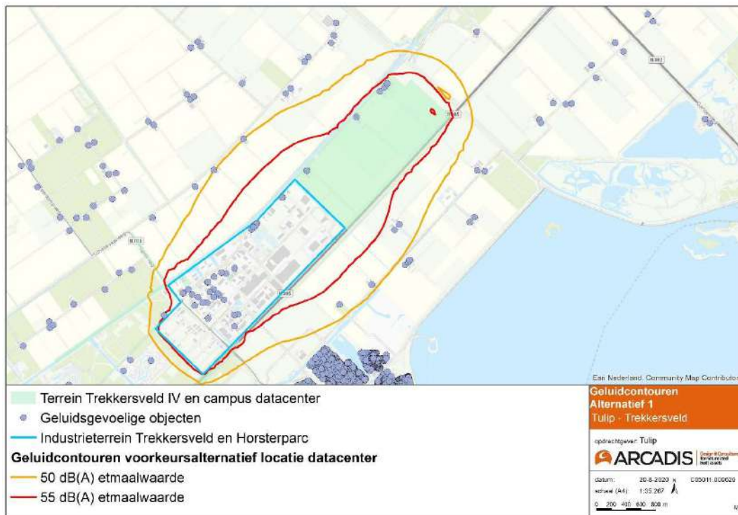
Figuur 16-18: Geluidcontouren bedrijventerrein Trekkersveld na uitbreiding met 35 hectare voor milieucategorie 3.2 inrichtingen en met campus met datacenter, transformatorstation en schakelstation
