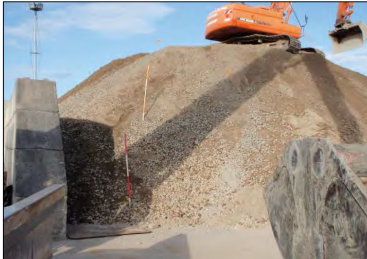
P2016-0548, Partijkeuring menggranulaat Zeewolde, foto 1
