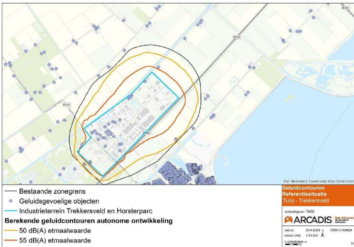
Figuur 16-1: Vigerende zonegrens en geluidcontouren 50 en 55 dB(A) etmaalwaarde bestaande bedrijventerrein Trekkersveld en Horsterparc huidige situatie en autonome ontwikkeling
