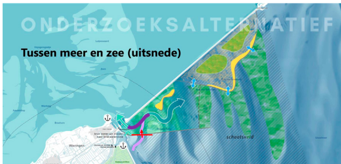
Afbeelding 6.3 Voorstel optimalisaties onderzoeksalternatief 2. Met in rood aangegeven de selectieve onttrekking door de leidam. In paars de geulen voor de Wieringerhoek en de brakwaterzone
