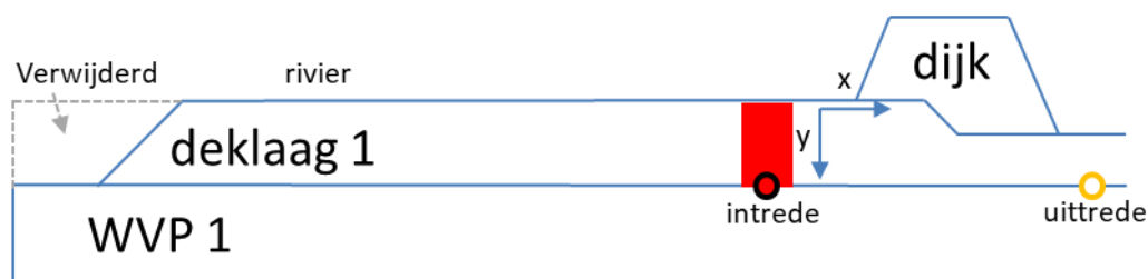
Figuur 7: Schematisering zwakke plek in deklaag binnen net buiten de 80 meter zone, met daaronder het intredepunt. De locatie van de zone met hoge doorlatendheid (rood) kan gevarieerd worden. WVP 1 staat voor watervoerend pakket 1. Ook het coördinatensysteem dat gehanteerd wordt is aangegeven.
