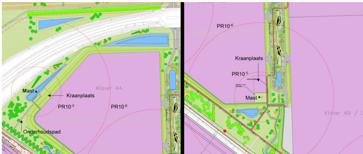
Figuur 8: Beoogde situatie turbinepositie 1 en 2
