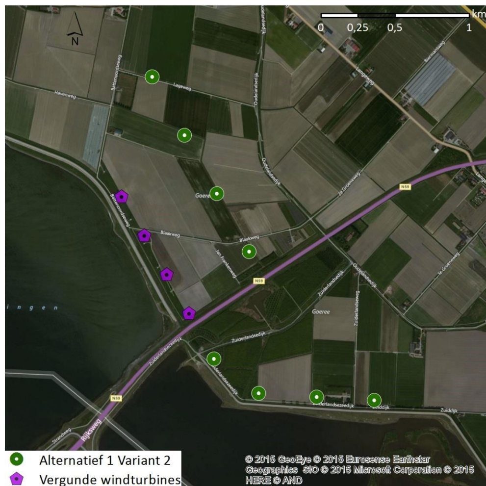
Figuur 51 - A1V2, bestaande uit 8 x Gamesa G132 met ashoogte 120 meter en rotordiameter 132 meter. Totaal vermogen: 40 MW.
