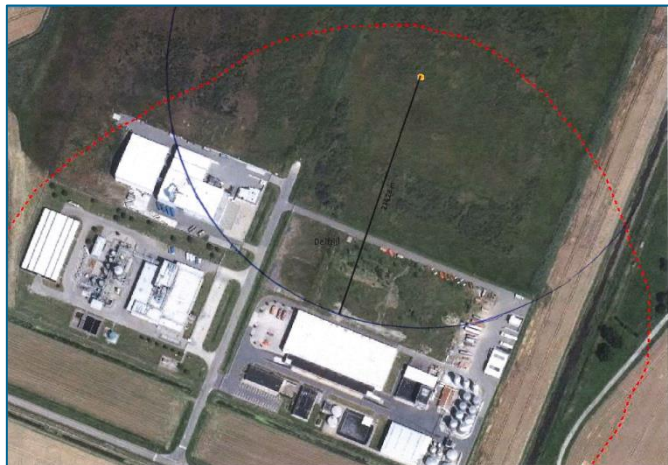
Figuur 4: reikwijdte werpafstand (234 m) overtoeren bij JPB (zwarte lijnen).
