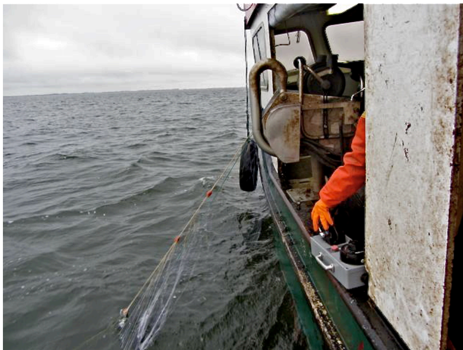
Figuur 2.1 Mechanisch binnenhalen van staand want net. Foto J. Bergsma.
