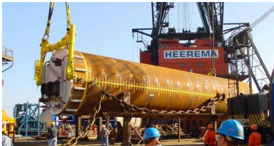
Afbeelding 3.12: Zuiganker zoals gebruikt in de offshore olie & gas industrie
