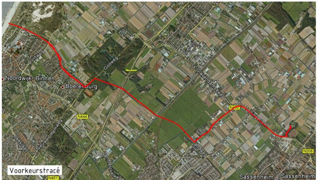
Afbeelding 2.5 Plantracé hoogspanningskabel Noordwijk – Sassenheim
