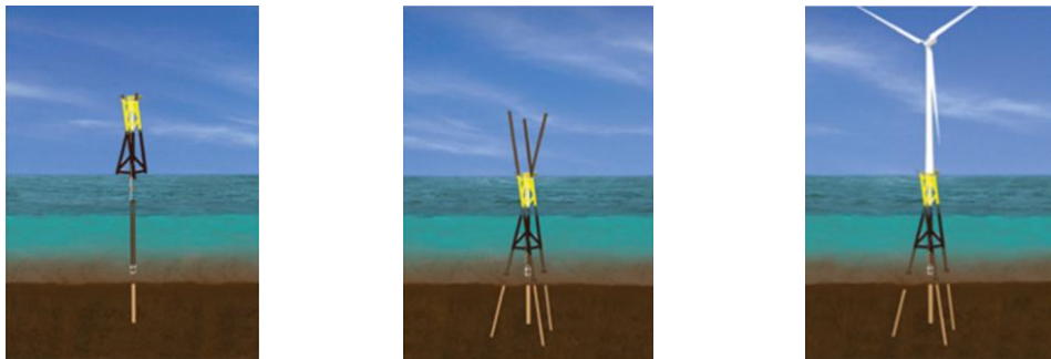
Afbeelding 3.9: Drie stadia in de installatie van een Twisted Jacket
