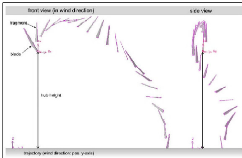
Afbeelding 9. een voorbeeld van een simulatie van het neerkomen van een rotorblad (flens naar beneden)
