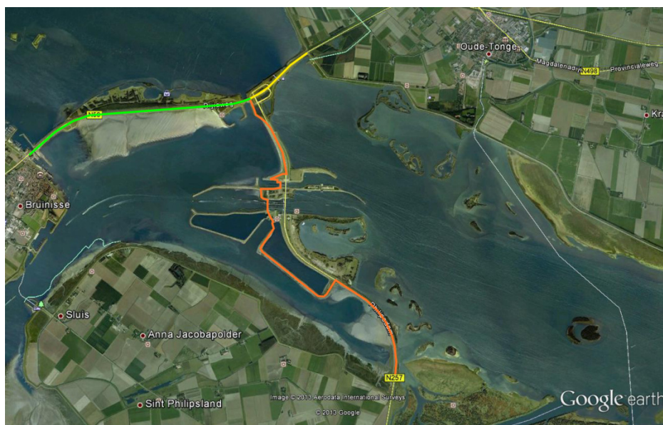
Afbeelding 5. verloop waterkerende deel verbindende waterkeringen Grevelingendam en Philipsdam (bron: Google Earth)
